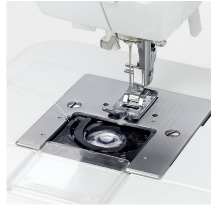
Sistema canilla flotante. Utilizado en la gama Bernette. La mayoría de marcas lo utilizan también en sus máquinas de mas calidad.
